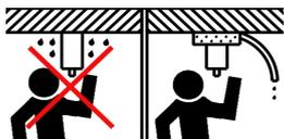
Trapanazione in verticale verso l'alto deve essere effettuata solo con dispositivo di raccolta dell'acqua.
