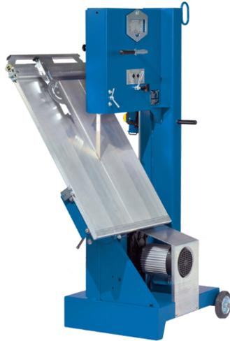
La posizione di trasporto della sega a nastro per cemento cellulare e laterizi (densità massima ROH1) prevede quanto segue:
