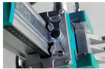
de montage sur le moteur. La plaque de montage comporte une clavette de 10x10x100 mm qui peut transmettre le couple du moteur. Placer ensuite la plaque de montage avec queue d'aronde dans le berceau. Serrer le boulon de verrouillage du berceau jusqu'à ce que la plaque soit fixée dans ce dernier.
