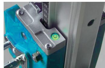
5.1.4 Utilizzando la livella a bolla d'aria sul carrello, regolare i quattro bulloni di livellamento per ottenere un buon posizionamento in piano, quindi stringere completamente i controdadi sui bulloni di livellamento. L'intero supporto deve essere montato saldamente. Sia la perforazione verticale che quella orizzontale condividono la stessa modalità di regolazione del supporto di perforazione fisso.
