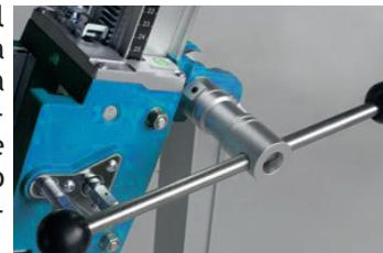
Una volta definito l'angolo, serrare il bullone di fissaggio per completare l'operazione. Serrare il bullone di fissaggio sul carrello per verificare che la piastra o la staffa di montaggio non siano allentate. Attenzione! Non serrare eccessivamente il bullone, altrimenti la parte posteriore della colonna e la base potrebbero deformarsi.
