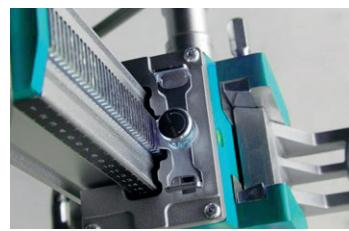
équipé d'un support de serrage et d'une entretoise de montage. Les deux méthodes de montage dépendent du type de moteur de forage. Par exemple, le DMP-162 est un moteur de forage portatif, il faut donc utiliser le support de serrage  $\Phi$  60 mm pour le monter sur le support
