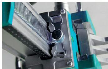
posizione desiderata e far scorrere la leva di blocco verso destra per bloccare il carrello in posizione. Una volta in posizione, sbloccarlo e stringere la vite M6 sul blocco della leva per avviare il funzionamento. Attenzione! Non sollevare o abbassare il carrello con il blocco della leva in posizione di bloccaggio, onde evitare danni alla cremagliera e al blocco.
