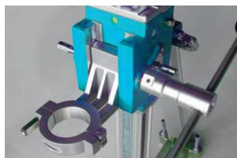
5.1.8 Prima di montare il motore sul supporto, regolare il carrello su una posizione più alta. Al termine della regolazione, utilizzare l'apposita leva per bloccare il carrello nella posizione desiderata.
