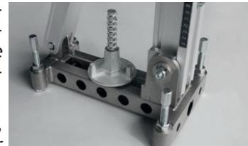
suffisante pour garantir une fixation parfaite de la base. Attention ! Lors du forage aérien, il est interdit d'utiliser une fixation par ventouse au plafond, car cela peut entraîner des blessures graves.
