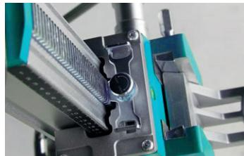
5.1.9 Quando si monta un motore a 4 bulloni sul supporto SEASTAND 250, utilizzare i 4 bulloni per installare prima il distanziatore sul motore. Sulla piastra di montaggio è presente una chiave da 10x10x100 mm in grado di trasmettere la coppia del motore. Quindi inserire la piastra di montaggio con coda di rondine nella base. Serrare il bullone di bloccaggio della base fino a fissare correttamente la piastra.
