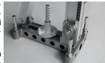
5.1.3 Eseguendo un fissaggio a vuoto, assicurarsi che la superficie di fissaggio sia piana e priva di impurità e che il vuoto sia sufficiente a garantire il perfetto fissaggio del basamento. Attenzione! Quando si esegue una perforazione aerea, non è possibile eseguire un fissaggio a vuoto sul soffitto, poiché ciò potrebbe causare gravi lesioni.
