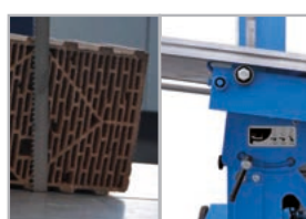
Taglio inclinato su mattoni con cavità vuote
